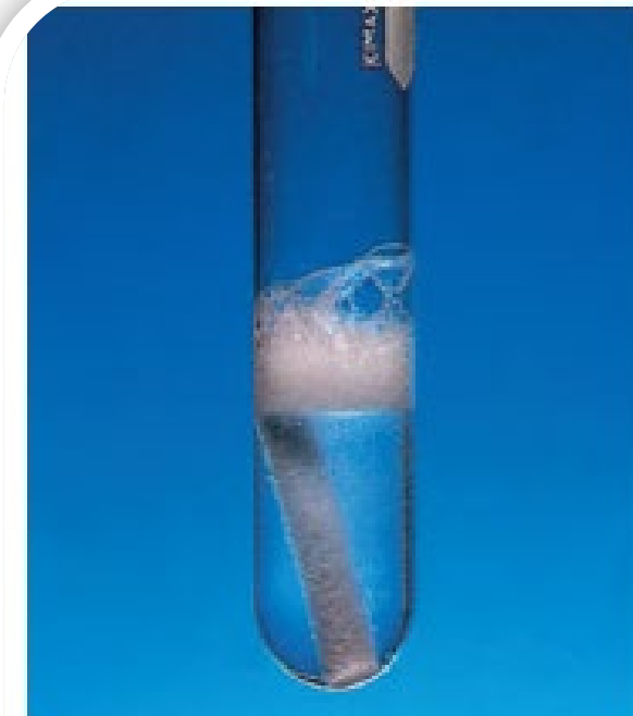
Figura 4.6 Un pedazo de tiza para pizarrón, compuesta principalmente por \text{CaCO}_3 , reacciona con ácido clorhídrico.
